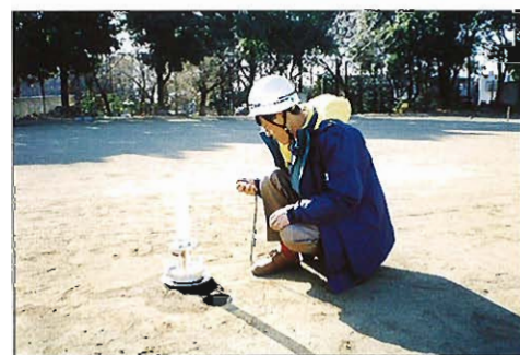
ランドフィルターの透水時間 10.4秒 ( 5.9 \times 10^{-2} /秒) (透水保水層)
